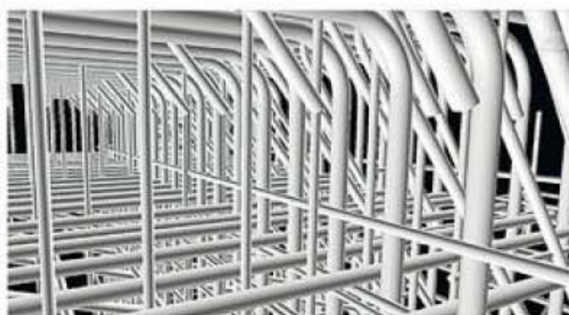
継ぎ手の部分も干渉しないように、あえて位置をずらしてモデリングした
