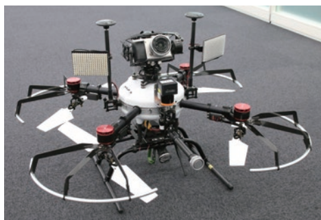
カメラを上部に搭載。鮮明なデータを取得するため、高輝度LEDを左右に備える。機体は田屋エンジニアリングが開発。
