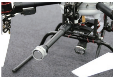
前方と上部には超音波式の障害物センサーを搭載。距離を設定することで、常に壁面との距離を一定に保つ。
